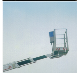
Kääntyvällä alumiini työkorilla päästään helposti työkohteisiin.
